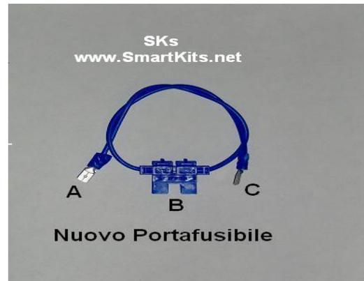
**Collegare il fusibile N.4 (30A) nel punto B del nuovo Portafusibile.**
