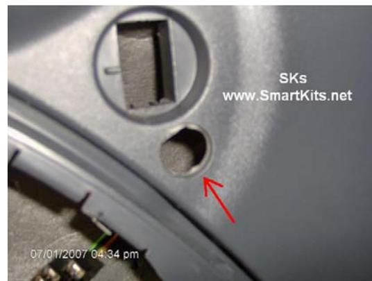
**Forare il pannello per il pulsante con una fresa da 31mm - 32mm.**
