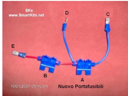
**Collegare il fusibile N.4 (30A) nel punto B del nuovo Portafusibile.**
