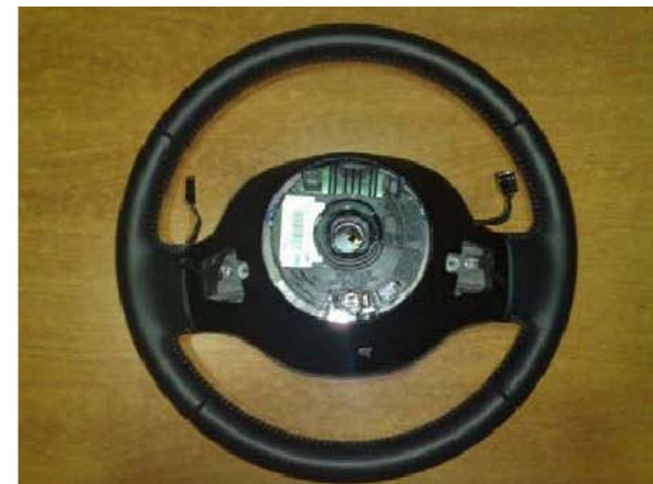
Posizionare il Cablaggio all'esterno del Coperchio Posteriore.
