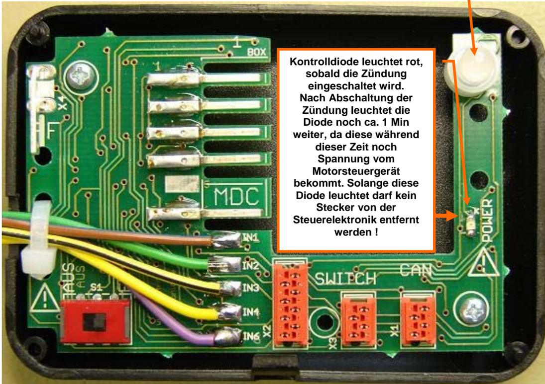
Kontrolldiode leuchtet rot, sobald die Zündung eingeschaltet wird. Nach Abschaltung der Zündung leuchtet die Diode noch ca. 1 Min weiter, da diese während dieser Zeit noch Spannung vom Motorsteuergerät bekommt. Solange diese Diode leuchtet darf kein Stecker von der Steuerelektronik entfernt werden !
