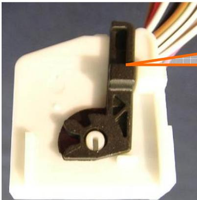
Diesen kleinen Hebel am Stecker des Tachoanschlusses umlegen und dabei den Stecker herausziehen
